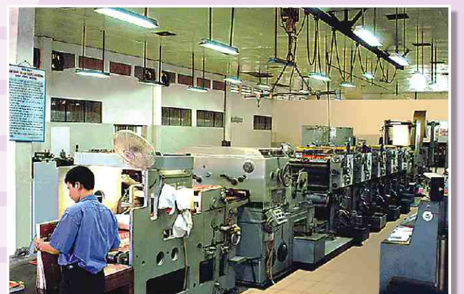
Hệ thống Máy in ống đồng 5 màu Goebel Damstadt - CHLB Đức
