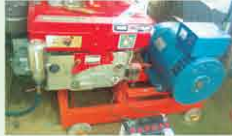
● Máy phát điện dùng khí biogaz được chế tạo từ máy dầu Diesel
